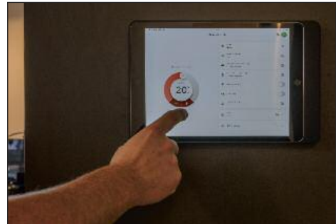
Die zentrale Steuerung der Heizungs-, Klima- und Warmwassertechnik erfolgt über die Daikin Onecta App.
