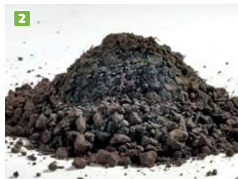
2 EXTENSIVSUBSTRAT E Dient als Vegetationstragschicht für Extensivbegrünungen
