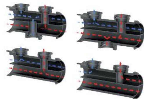
Das Grundmodul des Zonenverteilers ist im Achsstand 90 oder 125 mm erhältlich und kann je nach Anwendung mit Segmenten für den hybriden Betrieb mit mehreren Wärmeerzeugern oder für den Anschluss von Pufferspeichern erweitert werden.
