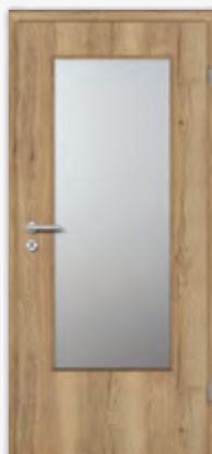
Türblatt CPL Touch Eiche Altholz DA, mit Vollspanplatte (VSP), Rundkante (RP), mit Lichtausschnitt (LA), mit und ohne Schlüsselloch- bohrung
