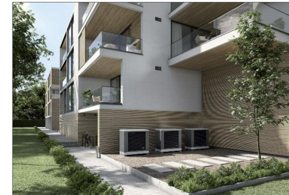
Speziell für höhere Heizleistungen in größeren Objekten können die x-change dynamic pro Wärmepumpen in einer Kaskade zusammengeschaltet werden. Mit bis zu drei hocheffizienten Modellen der neuesten Generation lassen sich so Leistungen von etwa 20 kW bis 60 kW erreichen. Vorteil gegenüber einem einzelnen, größeren Wärmepumpen: Flexibilität bei der Planung und eine hohe Ausfallsicherheit.
